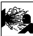
Ne retirez jamais le couvercle du refroidisseur si le groupe électrogène est chaud. De la vapeur et des jets de liquide de refroidissement chauds sortiront du moteur et pourront vous brûler gravement. Laissez le moteur refroidir avant de tenter de retirer le couvercle du refroidisseur.
